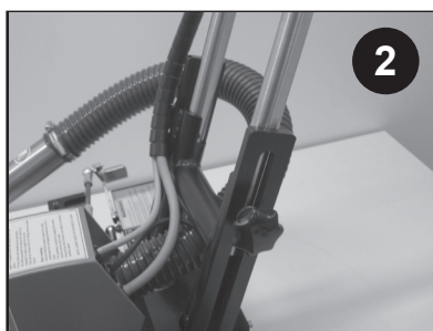
2. Fäll upp handtaget och justera till lämplig höjd för användaren.
