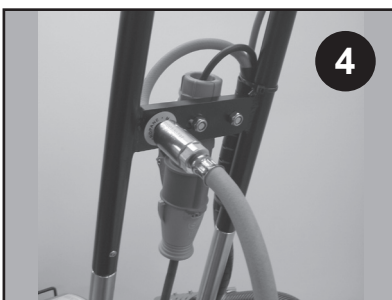
4. Schnellanschluss an der Gasquelle anschließen. Hinweis! Propan, max. 3 Bar. Auf Gaslecks prüfen.
