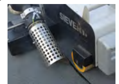
Saldatura bitume modificato
