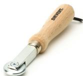
Rouleau de pression en métal extra fin pour le soudage des feuilles en PVC et l'installation de revêtements de sols. Roulements à billes, rouleau métallique bombé extra fin, manche ergonomique en bois pour un maximum de pression.
