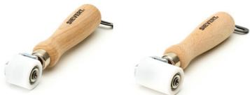
Rouleaux de pression anti adhésifs pour le recouvrement par soudage. Doubles roulements à billes, axe vissé, manche ergonomique en bois pour un maximum de pression, bras unilatéral.
